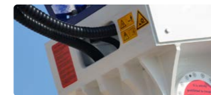
Специальный кронштейн для защиты гидравлических шлангов
