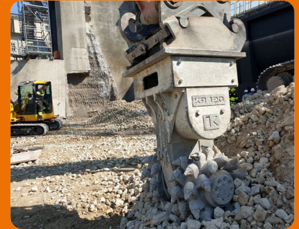
Die Querschneidkopffräse KR 120 von KEMROC in Nahaufnahme. Der Verschleiß an ihren Hartmetallmeißeln war bei diesem Einsatz im Stampfbeton gering.
