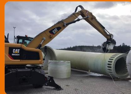
Ein Umschlagbagger Cat MH3024 mit einer Diamantsäge des Typs KEMROC KDS 50 verwendet EURECUM, um Windkraft-Rotorblätter zu zerkleinern.
