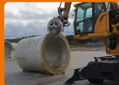
Nach dem Vorzerkleinern werden die einzelnen Elemente mit der hydraulisch angetriebenen Diamantsäge in noch kleinere Stücke zerschnitten.
