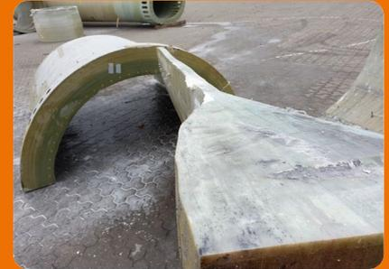
Das Verfahren von EURECUM hat sich schon vielfach in der Praxis bewährt. Diese Stücke aus GFK sind fertig für die automatisierte Nachzerkleinerung.
