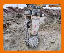
Die Kettenfräse in Nahaufnahme: Zwischen den seitlichen Schneidköpfen läuft eine Fräskette mit Hartmetallmeißeln. Sie entfernt den normalerweise entstehenden Mittelsteg aus Gestein.
