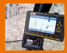
Techniker des KEMROC-Handelspartners Beutlhauser installierten eine Maschinensteuerung in der Baggerkabine. Damit kann der Maschinist auf wenige Zentimeter genau den Graben ausheben.
