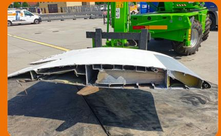
Die Diamantsäge ermöglichte ein präzises, sauberes und gezieltes Arbeiten. So kann ein größtmöglicher Teil der zerlegten Boeing 707 im originalen Zustand versteigert werden.
