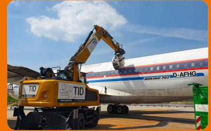
Das Ende eines Veteranen ist gekommen: Am 10. Juni 2021 zerlegten Abbruchexperten von TID eine 65 Jahre alte Boeing 707. Sie verwendeten eine KEMROC-Diamantsäge KDS 50 am firmeneigenen Umschlagbagger.
