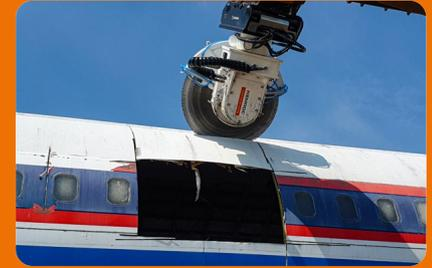
Auch der Rumpf und die übrigen Teile der Maschine wurden zersägt. Dabei erzielte die Diamantsäge eine ähnliche Schneidleistung wie eine herkömmliche Schrottschere.
