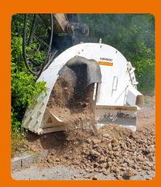
In einem Arbeitsgang werden Boden und Gestein oder Asphalt mit dem Schneidrad gelöst und das Fräsgut aus dem Auswurfgehäuse seitlich ausgetragen.
