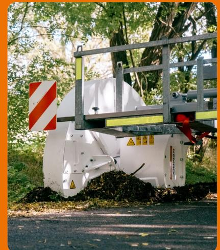
Zur Montage des KEMROC-Schneidrades SMW 80 (80 kW) wurde eigens eine Haltevorrichtung für die Radladerschwinge angefertigt. Damit lässt sich das Anbauwerkzeug eintauchen und führen.
