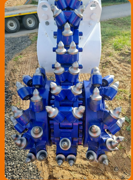
Detailansicht der KEMROC-Kettenfräse: Zwischen den beiden seitlichen Schneidköpfen läuft eine mit Hartmetallmeißeln bestückte Fräskette.
