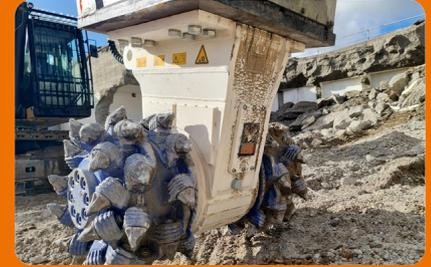
Die KEMROC-Querschneidkopfräse KR165 in der Nahaufnahme. Zu ihren Merkmalen gehören eine kurze und kompakte Bauweise sowie der Direktantrieb.
