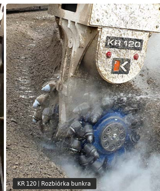
Specjalna obudowa z osłoną przewodów hydraulicznych
