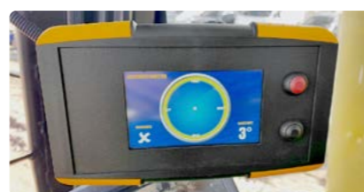
Controllo di allineamento
