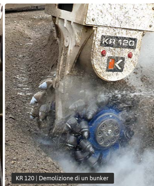
Alloggiamento con protezione del tubo idraulico.
