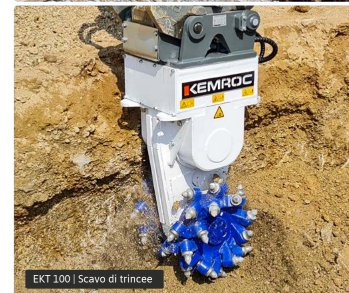
EKT 100 | Scavo di trincee
