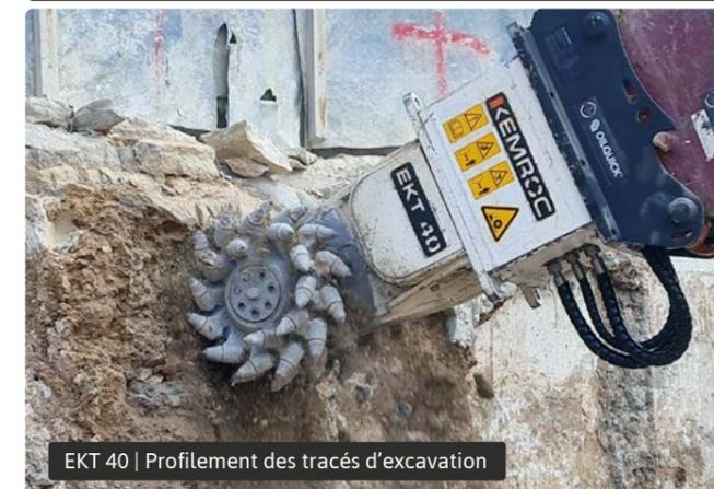
EKT 40 | Profilage des tracés d'excavation
