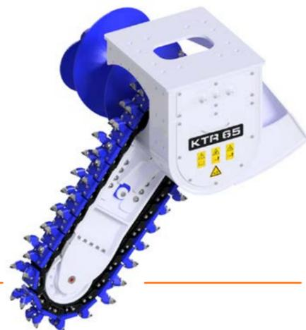
La trancheuse KTR peut creuser des tranchées avec des profils parfaits pour des largeurs de 17 à 45 cm et une profondeur maximale de 1,8 mètres. Disponible avec des chaînes de différentes largeurs et équipées de pics résistant à l'usure.
