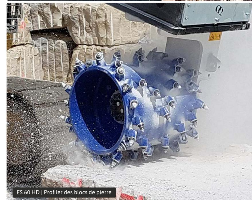
Vous trouverez un aperçu es pics standards aux pages 45 à 47. Selon l'application, les tambours de coupe peuvent être équipés de différents types de pics compatibles au modèle de porte-pic utilisé.
