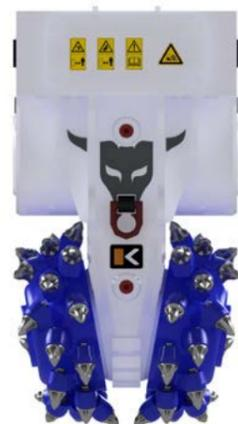
La gamme KRC de fraises Bullhead est équipée de deux tambours de coupe disposés en angle l'un par rapport à l'autre, de sorte que les deux ensembles de pics couvrent la totalité de la surface sans aucun espace entre eux, éliminant ainsi la nécessité de faire pivoter la coupeuse d'un côté à l'autre. L'utilisation de la coupeuse
