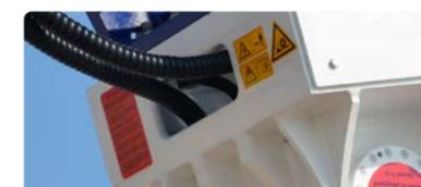
Dispositif de protection des flexibles
