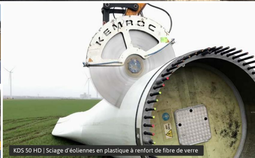
KDS 50 HD | Sciage d'éoliennes en plastique à renfort de fibre de verre
