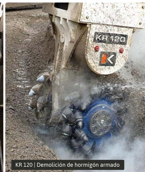
KR 120 | Demolición de hormigón armado
