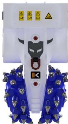
Las fresadoras Bullhead de la gama KRC tienen dos cabezales de fresado dispuestos en ángulo entre sí, cuyas picas de carburo están tan juntas que en la mayoría de las rocas no hay una cresta central que habría que eliminar moviendo lateralmente el brazo de la excavadora. El resultado es un fresado
