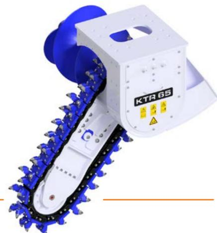
Infine, il materiale fresato viene trasportato attraverso uno speciale contenitore di scarico o un trasportatore a coclea e depositato accanto alla trincea.
