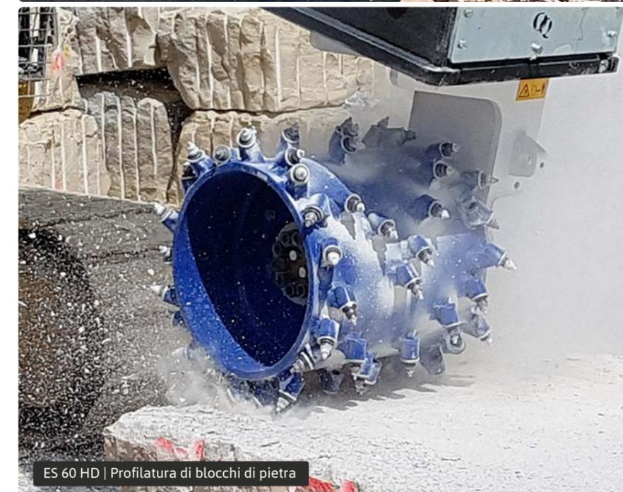
Per una panoramica dei picchi standard, vedere le pagine 45 a 47. A seconda dell'applicazione, le frese a tamburo possono essere fornite con una scelta di picco a seconda del tipo di portapicco usato.
