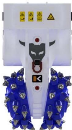
Le Bullhead frese della gamma KRC sono dotate di due tamburi di taglio disposti ad angolo l'uno rispetto all'altro, in modo che le due serie di picchi coprano l'intera superficie senza alcuno spazio tra di loro, eliminando la necessità di far oscillare la fresa da un lato all'altro. Il funzionamento
