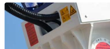
Alloggiamento con protezione del tubo idraulico.
