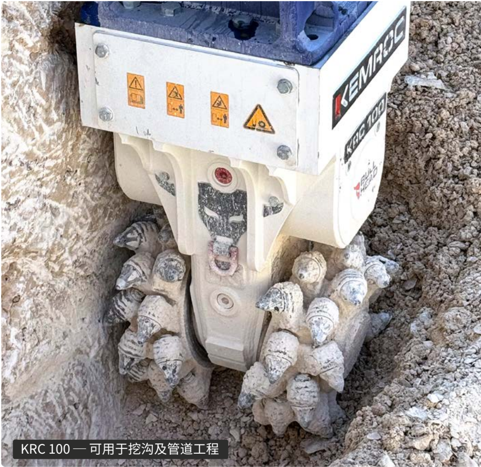
KRC 140 — 可用于挖沟及管道工程
