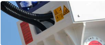
Carcaça com proteção para mangueiras hidráulicas.
